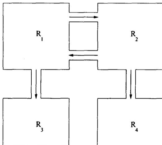
Les "tuyaux" reliant les différents réservoirs schématisent en fait des membranes semi-perméables qui ne laissent passer le gaz que dans le sens indiqué par la flèche.
