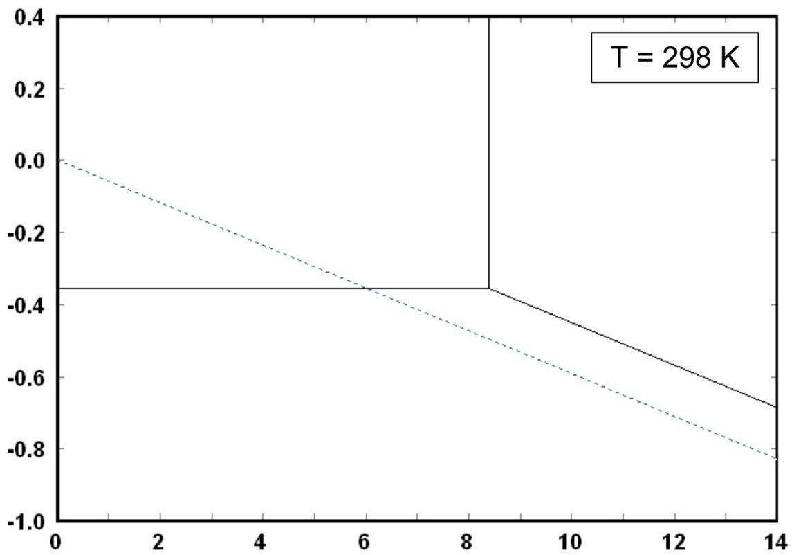
Fig. 1. Diagramme potentiel-pH du système nickel-eau prenant en compte les trois espèces  $\text{Ni}_{(s)}$ ,  $\text{Ni}(\text{OH})_{2(s)}$ ,  $\text{Ni}^{2+}_{(aq)}$ . Concentration de l'espèce dissoute :  $1 \times 10^{-4} \text{ mol.L}^{-1}$ .
