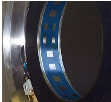
Figure 21 - Photographie du capteur inductif
