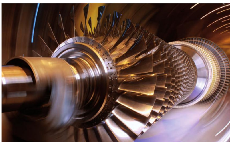
Figure 12 La turbine étudiée (on ne visualise ici que le rotor comportant les étages mobiles des différents corps)
