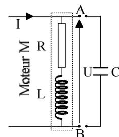
14. Pour relever le facteur de puissance de l'installation, on connecte entre les bornes A et B un condensateur de capacité C. La tension mesurée aux bornes du moteur a toujours la valeur  $U = 220 \text{ V}$ . Calculer la plus petite valeur de C pour que le nouveau facteur de puissance soit égal à 0,9.
