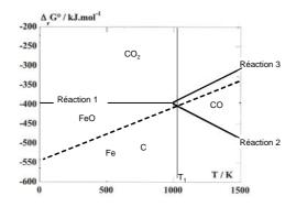
La lecture du diagramme montre que FeO et C n'ont un domaine d'existence disjoint que pour  $T > T_1$ . L'élaboration du fer à partir de l'oxyde de fer en utilisant le carbone n'est donc possible que si  $T > T_1$ .
