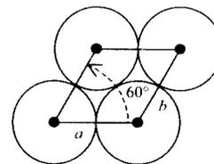
On a  $a = b = 2R_{sil}$ , l'aire de la maille du plan est donc  $4R_{sil}^2 \sin(60^\circ) = 2\sqrt{3}R_{sil}^2$  : cette maille contient en propre une sphère, qui masque la surface  $\pi R_{sil}^2$  : la proportion de surface masquée est donc  $\frac{\pi}{2\sqrt{3}} = 0,91 \approx 1$  : la proportion de
