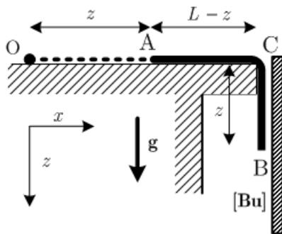
Fig. 4 : Chute d'une corde AB de longueur  $L$  dans le plan vertical  $(x, z)$ . La longueur de la partie verticale CB est  $z$  ( $z > 0$ ). La corde occupe initialement le segment OC, avec  $OC = L$ . Le butoir [Bu] garantit que le mouvement de la partie CB de la corde est bien vertical.
