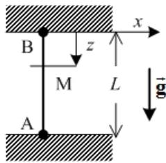
La corde est à nouveau verticale, fixée en ses deux extrémités A et B (Fig. 5). L'axe des  $z$  est toujours orienté vers le bas et l'origine est maintenant à l'extrémité B : les points O et B coïncident. L'axe Ox est dans un plan horizontal. La tension de la corde au point A,  $T(A)$  est très grande devant le poids de la corde :  $T(A) \gg m_T g$ . La position d'un point M de la corde est repérée par sa cote  $z$  dans un référentiel galiléen lié à B.
