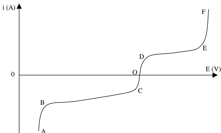
$i$  représente l'intensité entre les deux électrodes de platine.
