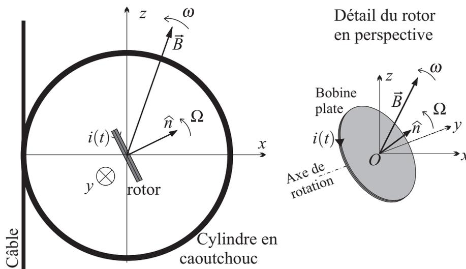
FIG. 5 – Éléments géométriques relatifs au moteur
