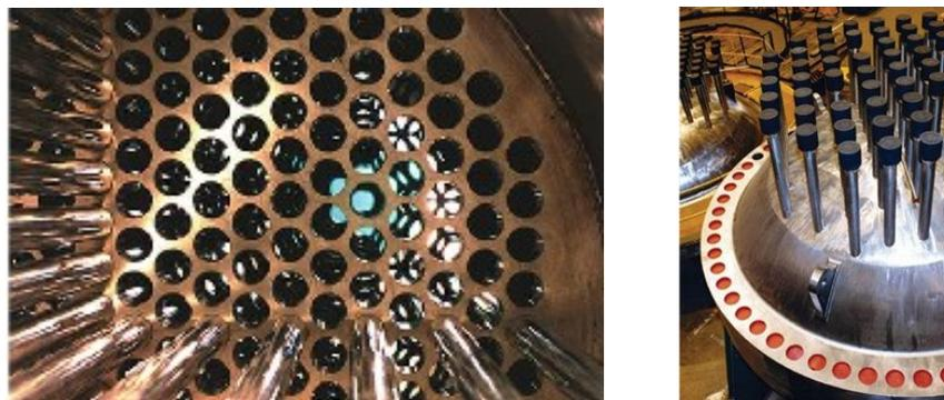
Figure 3 : photos des tubes du générateur de vapeur.
