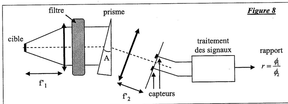
41. Expliquer comment ce montage permet de pouvoir récupérer simultanément deux signaux électriques correspondant aux deux longueurs d'onde  $\lambda_1$  et  $\lambda_2$ . On exprimera notamment la déviation angulaire provoquée par le prisme de petit angle  $A$  et d'indice de réfraction  $n$ , fonction de la longueur d'onde  $\lambda$  selon la loi empirique :  $n(\lambda) = a + \frac{b}{\lambda^2}$ .
