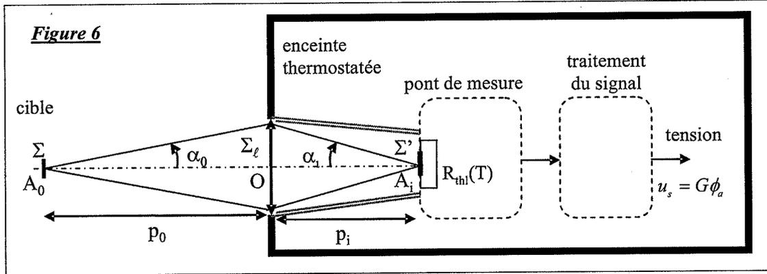
Le pyromètre optique collecte le rayonnement émis en provenance d'une partie du corps que l'on appellera la cible. La fenêtre d'entrée du pyromètre est une lentille convergente, de centre optique O, de focale image  $f'$  et de diamètre D. On note  $\Sigma_\ell$  la surface utile de la lentille.
