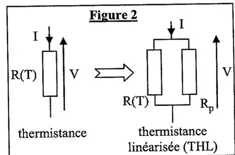
4. Montrer que la linéarisation au voisinage d'une température T<sub>l</sub> correspond mathématiquement à l'existence d'un point d'inflexion de la fonction R<sub>//</sub>(T) pour la température T<sub>l</sub> (soit  $\left. \frac{d^2 R_{//}(T)}{dT^2} \right|_{T=T_l} = 0$ ).
