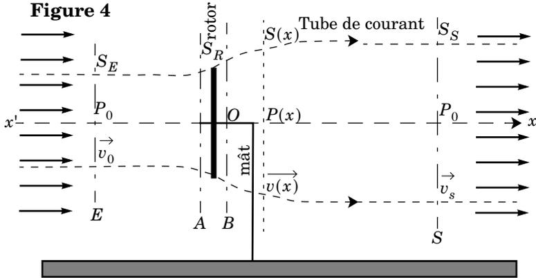
*Schéma du tube de courant s'appuyant sur le pourtour du rotor de l'éolienne. La vitesse et la pression loin en amont sont uniformes ( $\vec{v}_0$  et  $P_0$ ). La pression loin en aval est uniforme  $P_0$  ; la vitesse n'est uniforme loin en aval qu'à l'intérieur du tube de courant considéré et vaut  $\vec{v}_s$ . les normes relatives de  $\vec{v}_0$  et  $\vec{v}_s$  n'ont pas été respectées sur ce schéma.*
