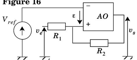
II.D.2) Déterminer et tracer le cycle associé à la caractéristique de transfert,  $v_s$  en fonction de  $v_e$ , du montage de la figure 16 en faisant apparaître le sens de parcours.
