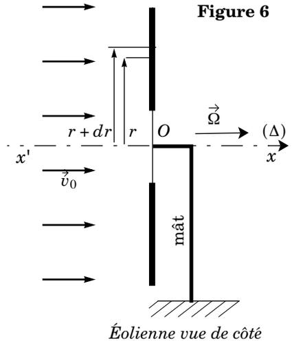
On utilisera le repère de coordonnées cylindriques  $(O, \vec{e}_r, \vec{e}_\theta, \vec{e}_x)$ . La figure 7 montre l'aspect du profil de la pale : elle a une longueur  $L$  et est inclinée d'un angle  $\alpha$  par rapport au plan de rotation du rotor,  $\alpha \in [0, \pi/2]$ .
