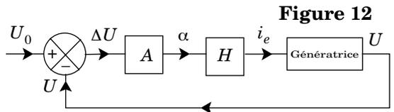
Le dispositif représenté par le bloc A, non détaillé ici, délivre le rapport cyclique suivant la relation  $\alpha = k \Delta U / U_0 + \alpha_0$ ,  $k$  étant une constante de réglage sans dimension.
