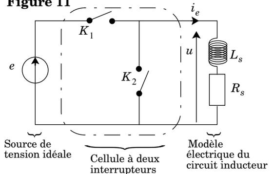
agit sur le courant inducteur  $i_e$  par l'intermédiaire d'un montage de commande. Le bobinage du stator se présente sous la forme d'un dipôle  $R_s, L_s$ . On insère entre la source d'alimentation et le bobinage, un convertisseur à deux interrupteurs représenté en figure 11. La source de tension idéale délivre une force électromotrice continue de valeur  $e$ .
