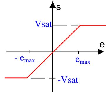
b) Avec  $e_{max} = V_{sat}/F$ , la caractéristique est représentée ci-contre.
