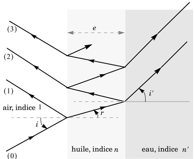
On rappelle, dans le cas d'indices réels, les valeurs des coefficients de réflexion et de transmission d'un dioptré en incidence normale :
