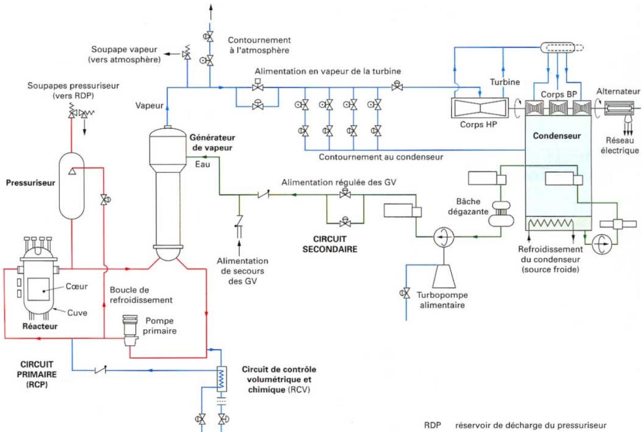
Figure 2 Schéma de principe de fonctionnement d'un REP
