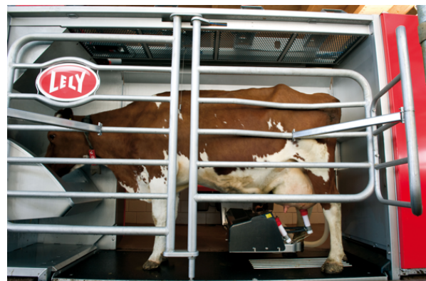
Figure 2 Vache en phase de traite et d'alimentation dans le box du robot de traite LELY Astronaut A3 (d'après plaquette LELY)
