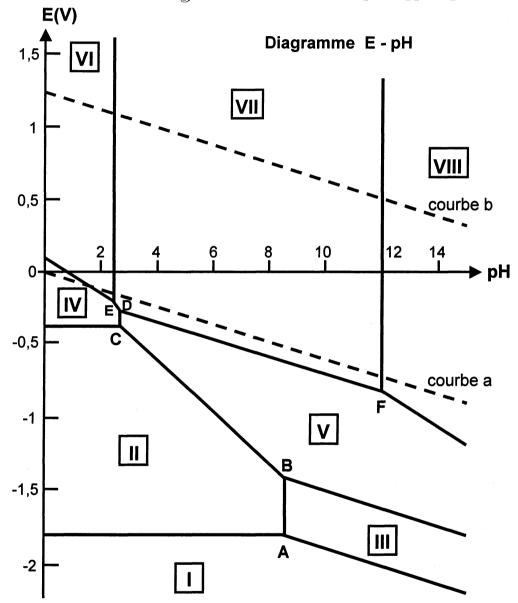
Les courbes a et b correspondent aux limites du domaine de stabilité de l'eau. Les coordonnées de quelques points remarquables sont données dans le tableau suivant :
