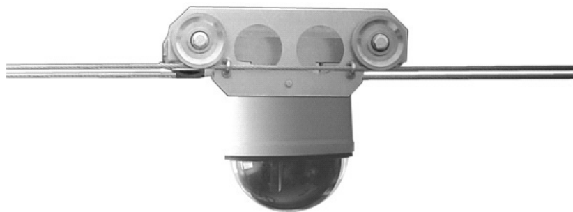
Figure 2 : Chariot (sans le capot supérieur) intégrant une caméra deux axes.
