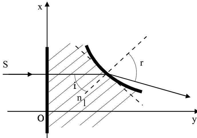
On cherche alors à déterminer la forme de la deuxième face. Pour simplifier le raisonnement, on suppose que la source lumineuse se trouve du côté de la face plane et que ses rayons sont parallèles à l'axe optique (voir schéma précédant). On suppose aussi que les angles mis en jeu dans le phénomène sont petits devant l'unité.
