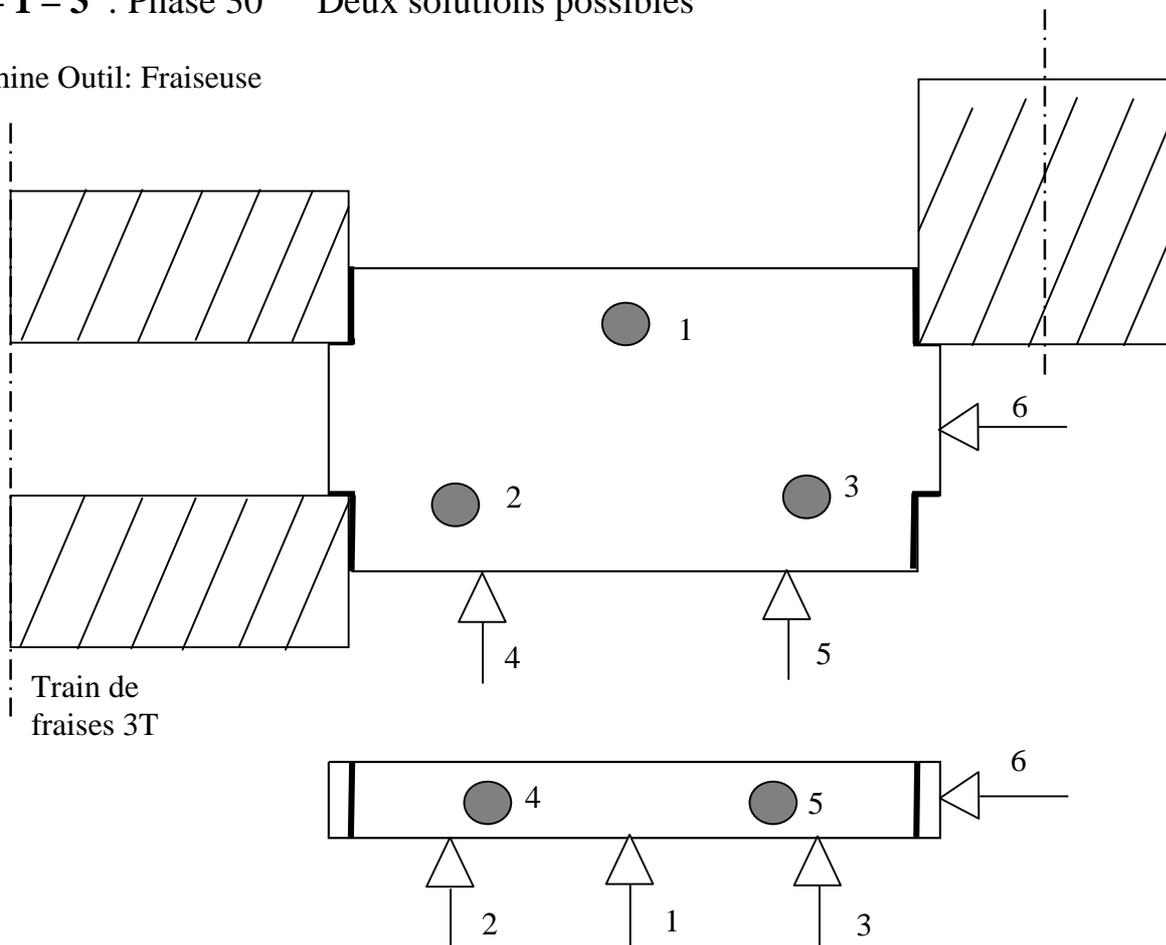
Maintient de la pièce sur montage d'usinage avec retournement .
