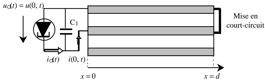
Fig. 5 : oscillateur à constantes réparties
