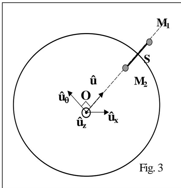
La Terre est entourée d'un champ magnétique  $\vec{B}$ . On admet que les lignes de champ à l'extérieur de la Terre sont équivalentes à celles que produit un moment magnétique Nord-Sud  $\vec{\mu}$  placé au centre O de la Terre, le pôle magnétique Nord étant voisin du pôle Nord géographique. Dans le système de coordonnées sphériques dont l'axe Oz est colinéaire au moment,
