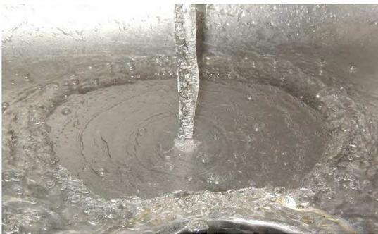
Le ressaut hydraulique est un phénomène que la plupart d'entre nous a observé dans un évier de cuisine : l'eau du jet qui frappe verticalement l'évier s'étale d'abord radialement en une mince nappe circulaire, de vitesse élevée. Pour une certaine valeur  $R$  de la distance au jet, l'épaisseur de la nappe augmente brutalement et sa vitesse diminue. La zone de discontinuité est ce qu'on appelle le *ressaut hydraulique*. Ce problème de mécanique des fluides avec des conditions
