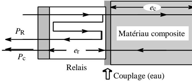
Fig. 8 : Transducteur, relais, coupleur et matériau
