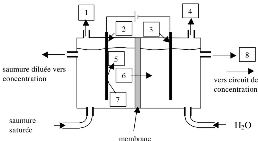
Les anodes sont de type DSA (Dimensionally Stable Anodes) en titane recouvert d'oxydes de titane et de ruthénium, les cathodes sont en nickel. La séparation entre les compartiments cathodiques et anodiques est constituée de membranes cationiques (perméables aux cations) très peu conductrices. Ces membranes sont des polymères perfluorosulfoniques (Nafion<sup>®</sup>) ou perfluorocarboxyliques (Flemion<sup>®</sup>).
