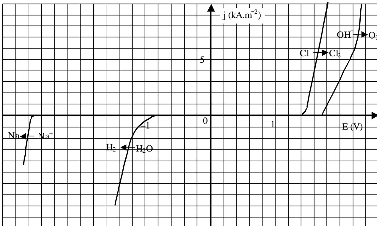
8- Quelle est la réaction qui a effectivement lieu dans ce procédé pour une valeur de densité de courant n'excédant pas les limites du tracé des courbes ?
