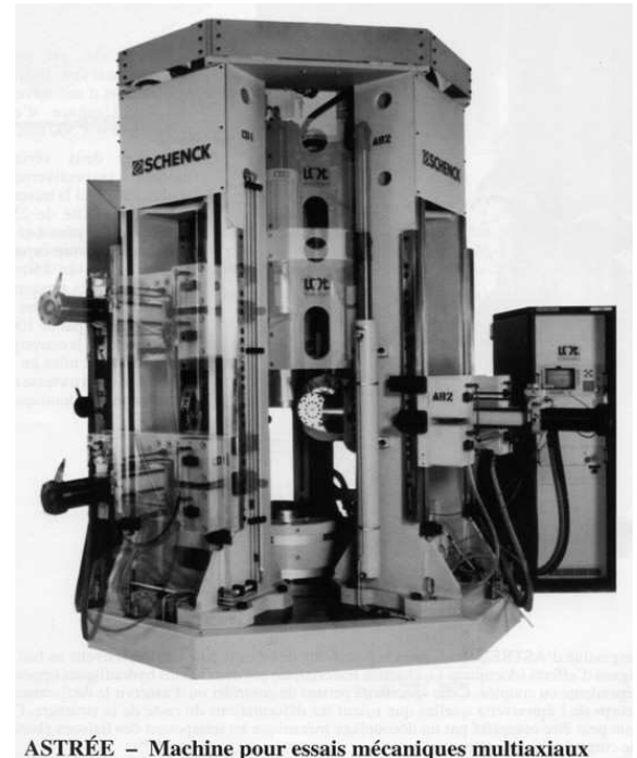
ASTRÉE – Machine pour essais mécaniques multiaxiaux
